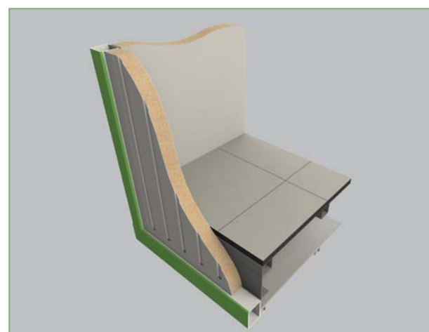
Конструкция МЦОДа для внутренней установки
